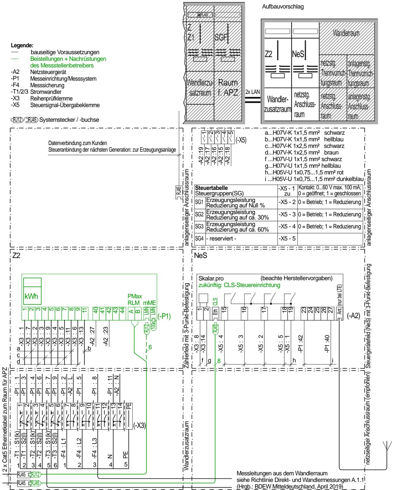
**Bild 2** Aufbau Zählerplatz / NeS-Platz Anlagenklasse 1 (Wandlermessung)
