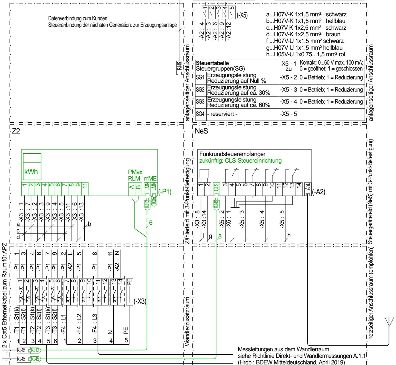
**Bild 2** Aufbau Zählerplatz / NeS-Platz (Wandlermessung)
