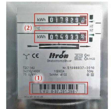
Ist bei Ihnen ein Doppeltarif-Zähler installiert, verfügt dieser über zwei Zählwerke. Ein Zählwerk ist mit **HT** (Hochtarif 06:00 – 22:00 Uhr), das andere mit **NT** (Niedertarif 22:00 – 06:00 Uhr) gekennzeichnet. Finden Sie einen solchen Zähler vor, notieren Sie bitte alle Zählerstände.
